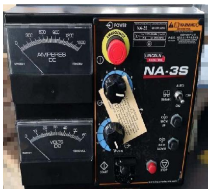
埋弧焊辅助电源
